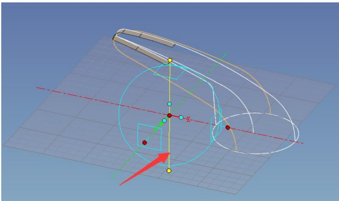
选三维球中心点，右键——到点（下线2 端点）
