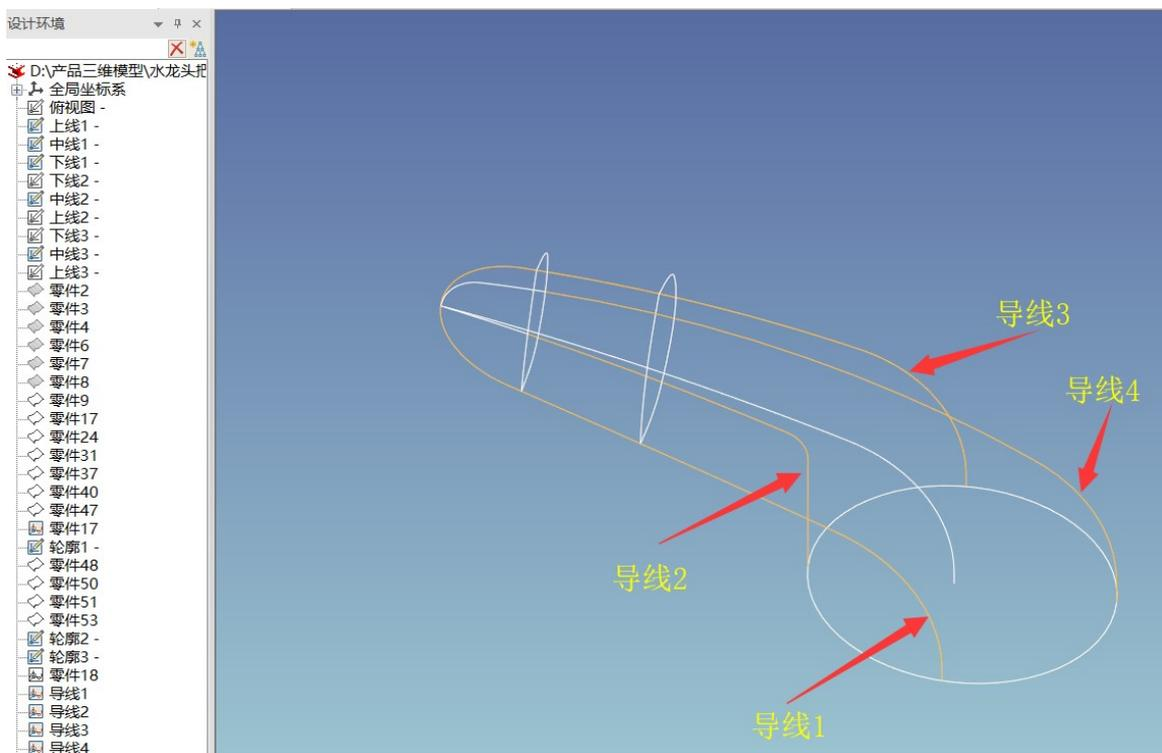
16、用放样工具，轮廓依次选择轮廓 1、轮廓 2、轮廓 3，导线依次选择导线 1、导线 2、导线 3、导线 4，点击确定。
