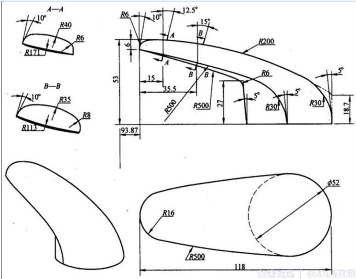
分析：根据图纸，可以采用放样工具进行建模，以 $\phi 52$ 、截面 A-A、截面 B-B 为轮廓，上下和前后四条束线为引导曲线。端部同样采用放样工具。下面以这个思路进行建模，主要过程是如何建立轮廓面和引导曲线。
