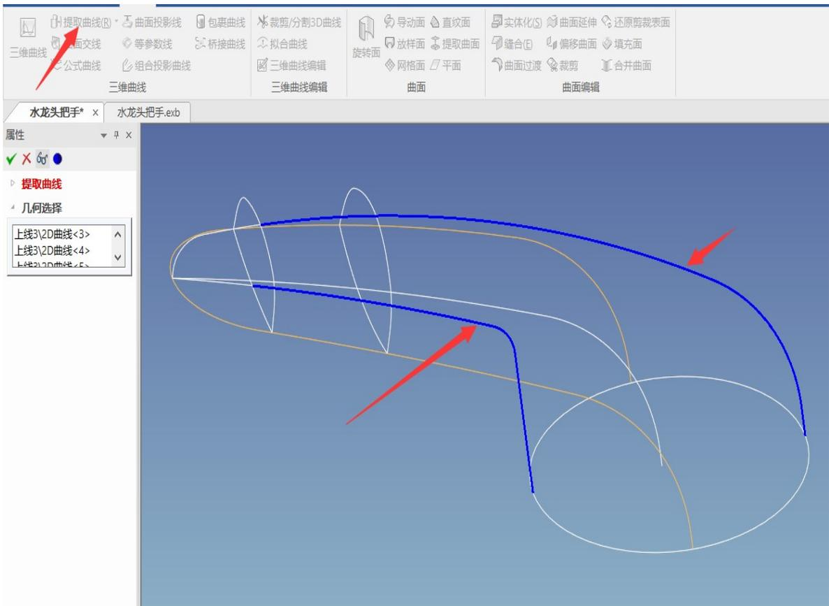
15、用拟合曲线工具，生成导线 1
