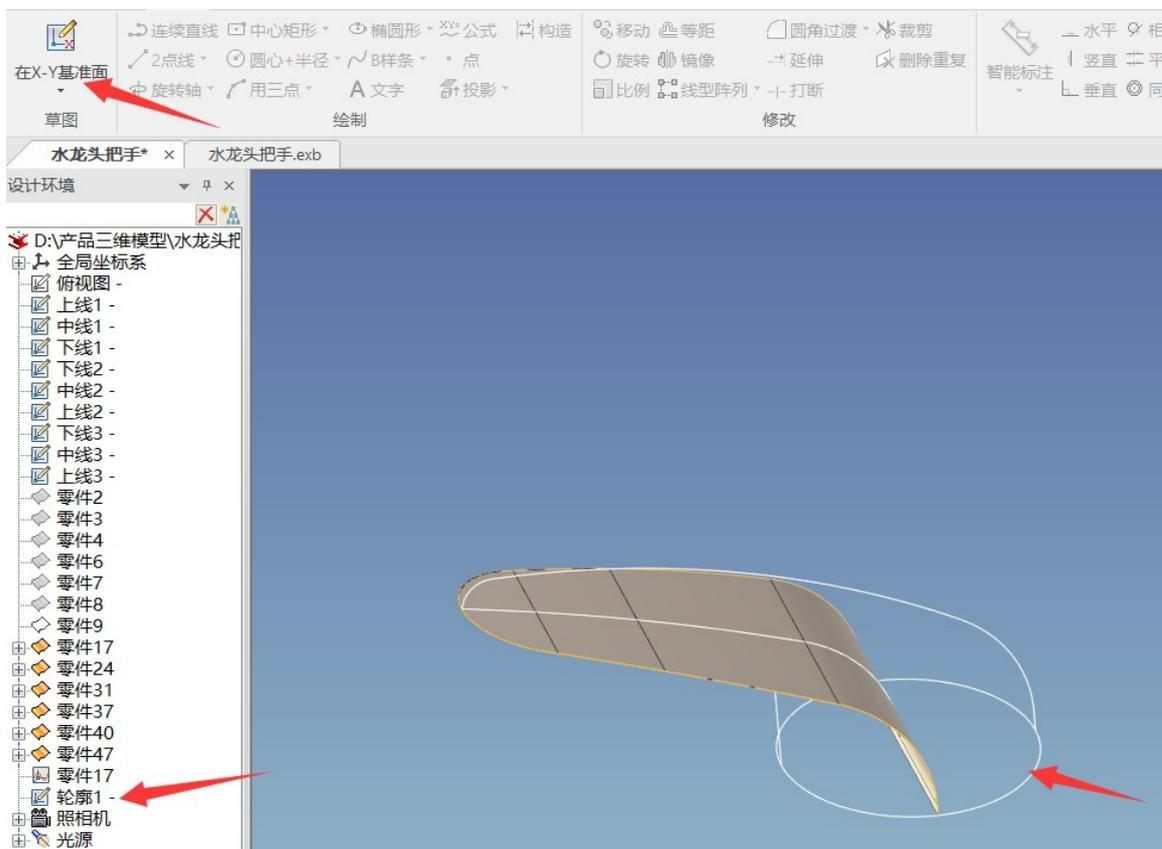
11、 选取上线 1 草图——右键——生成——拉伸——曲面——长度 5
