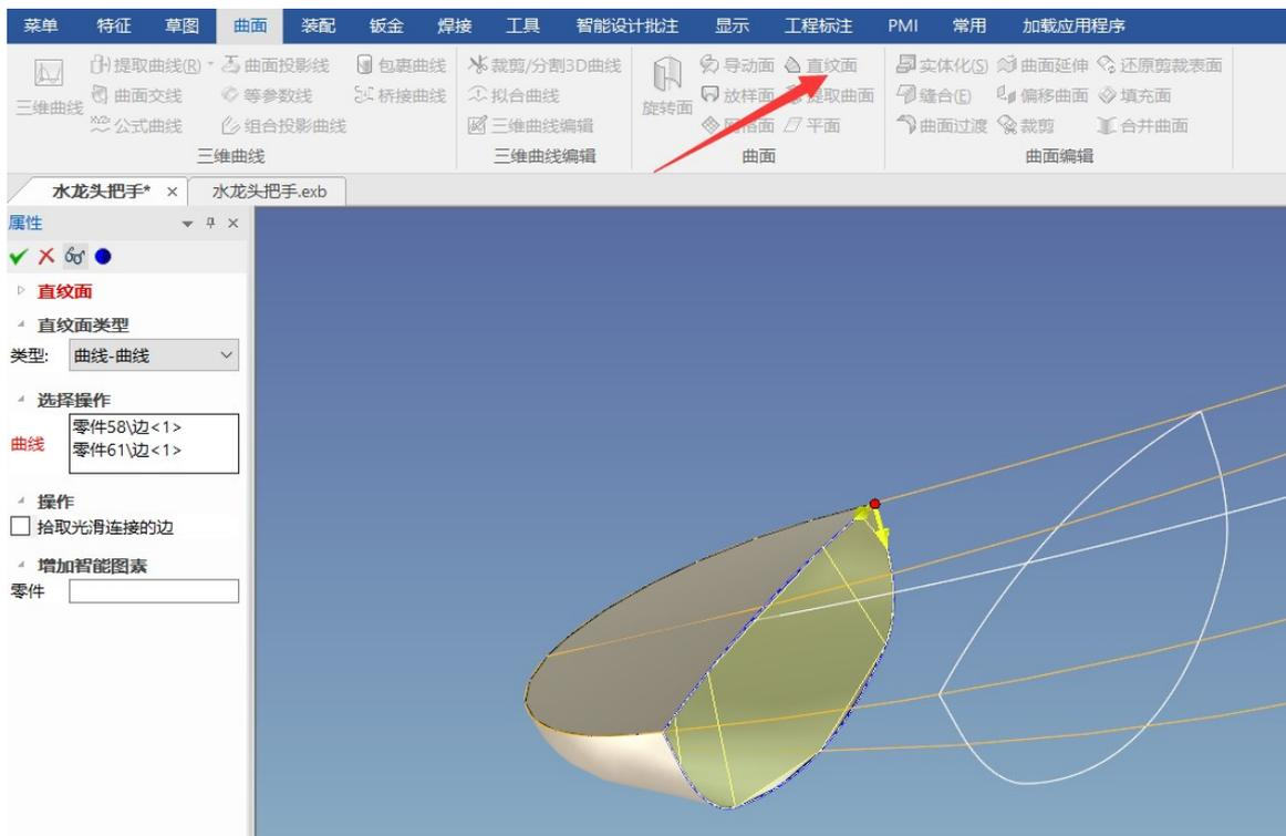
20、用曲面中的实体化工具，实体化尾部
