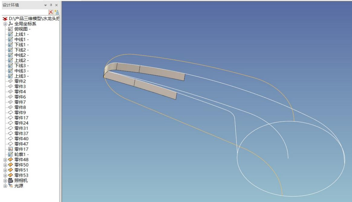
12、新建草图轮廓 2，选新建草图 X-Y 基准面
