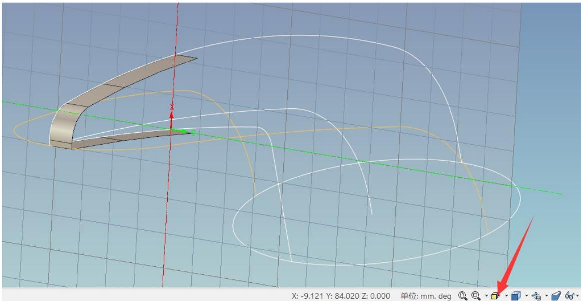
取消中线曲面的压缩，并单击投影工具，分别选取曲面的边，生产如图所示的线条（为了绘制 B-B 草图，找到相应的点）
