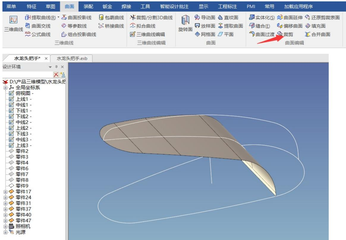
9、 选取提取曲线——选择裁剪后的曲面边——提取曲线
